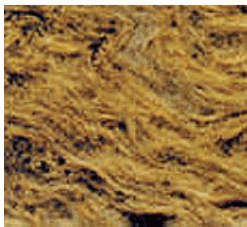
Vista microscópica de las fibras de la lana mineral de roca.
