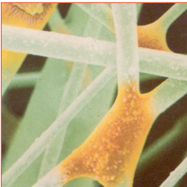
Vista microscópica de las fibras de la lana mineral de roca.
