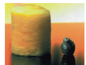
FIBRA DE VIDRIO ANTES Y DESPUÉS DE LA PRUEBA DE FUEGO
